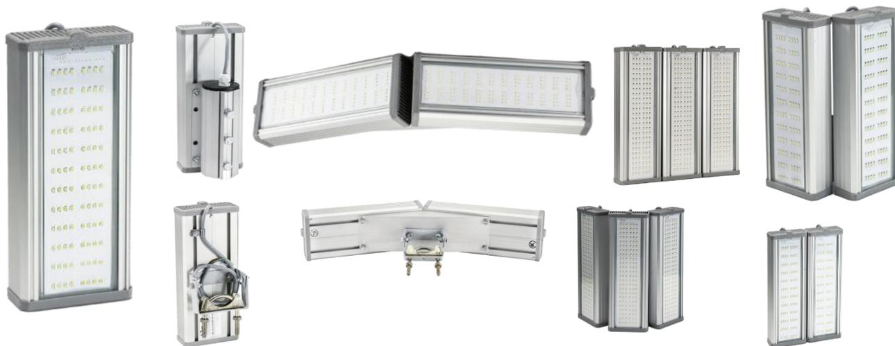
Светильники имеют высокие показатели освещенности при сниженном энергопотреблении. Так, потребляя 64 Вт, светильники дают освещенность, аналогичную лампам ДРЛ 250 Вт, Светильники 48 Вт-соответствуют световому потоку дуговых ртутных ламп в 150 Вт. Корпус из анодированного алюминия легко монтируются благодаря унифицированному, консольному креплению.
